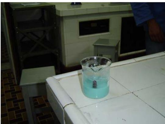
**Figura 21** – Adicionando um fragmento de ferro na calda bordalesa
