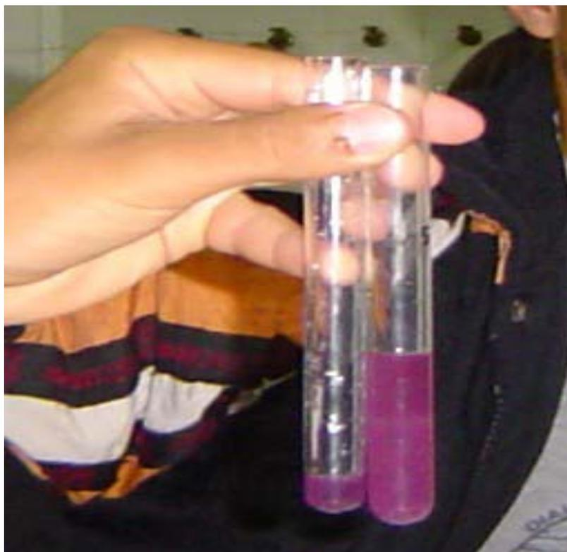
**Figura 14** - Comparação da amostra de solo com o padrão
