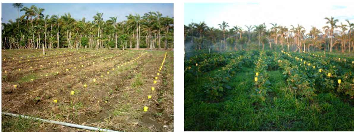
Figura 3 - Localização dos coletores para determinação da lâmina de irrigação aplicada
