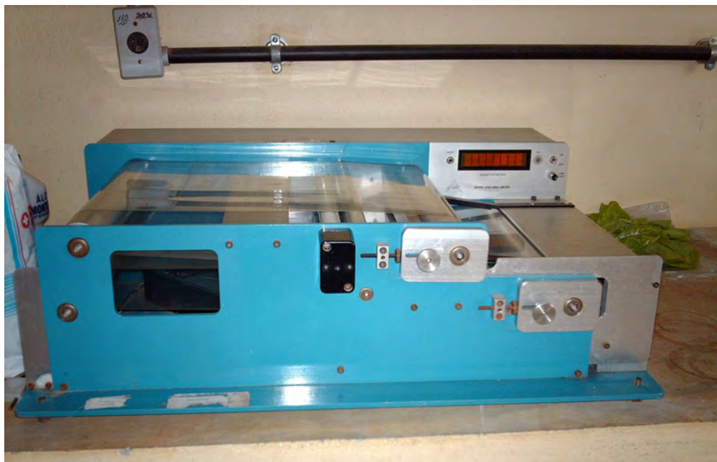
Figura 41 - Integrador fotoelétrico LI-3000, LICOR utilizado para determinação da área foliar das plantas de berinjela.
