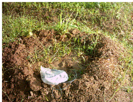
Figura 7 - Bacia de calibração das sondas TDR em condições de canteiro.
