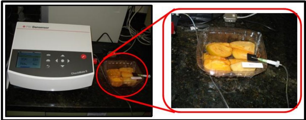
Figura 17. Aparelho PIB - Dansensor conectado à barquete para se fazer a leitura da amostra.
