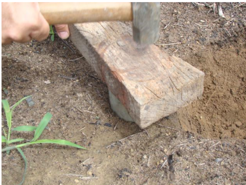
Figura 5. Cilindro de coleta de solo sendo inserido no solo.
