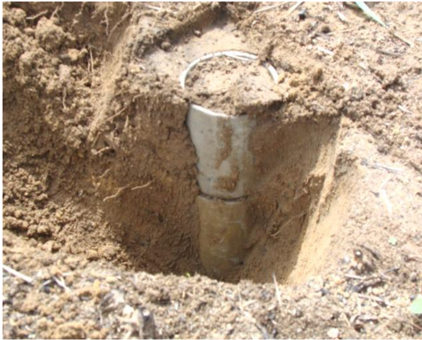
Figura 6. Cilindros de coleta inseridos no solo.
