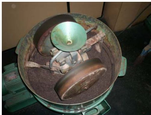
Figura 1. Misturador de laboratório com as duas mós e o funil para abastecimento de água
