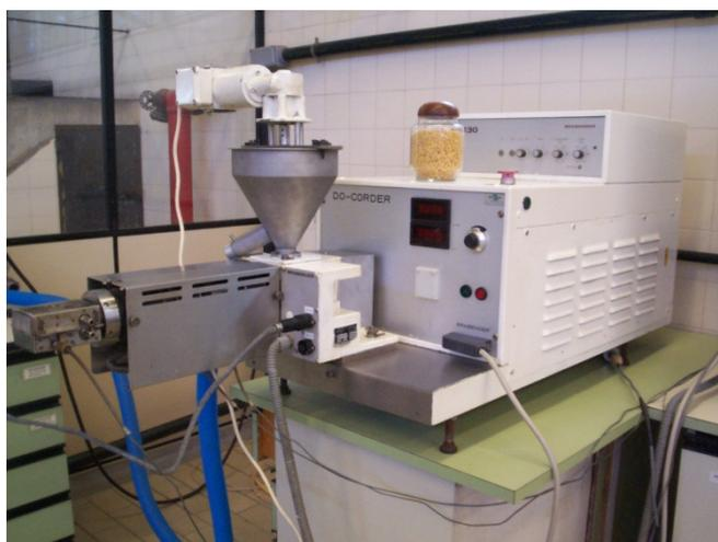
**Figura 8.** Extrusor Brabender mono-roscas utilizado para a produção das massas pré-cozidas
