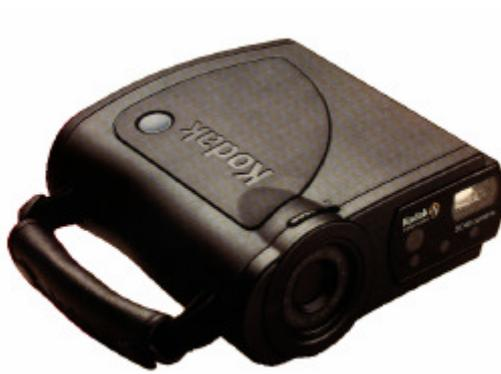
Figura 10. Câmera fotográfica digital Kodak DC 40 utilizada para captura de imagens.
