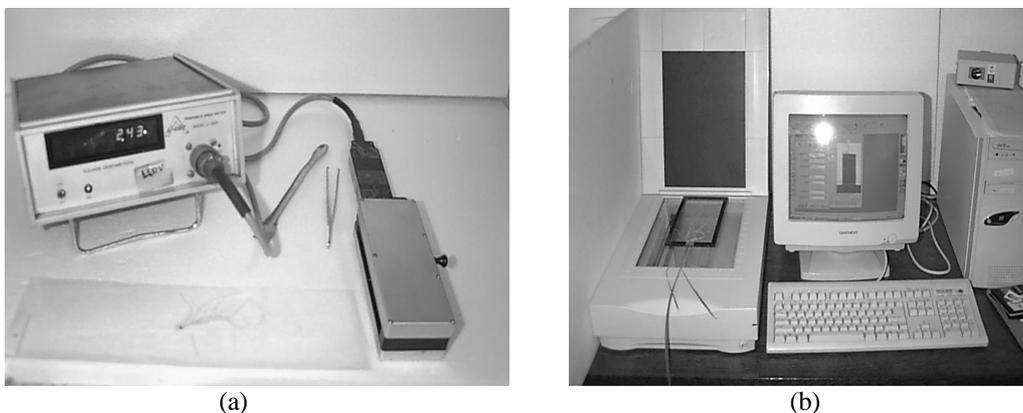
Figura 9. Medidor fotoelétrico licor, modelo LI 300 (a) e sistema computacional para aquisição de imagem via *scanner* (b).
