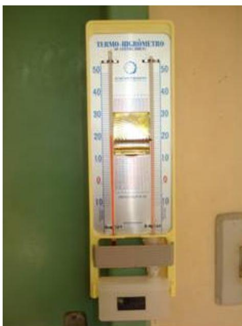
**Figura 1** – Psicrômetro sem ventilação forçada.
