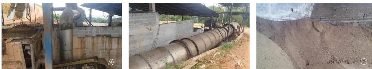
**Figura 2.** Sistema de desidratação de esterco de galinha poedeira. A – Moega recebendo esterco fresco e deslocando para cilindro desidratador por meio de esteira. B – Cilindro desidratador. C – Esterco desidratado sendo acumulado para comercialização.
