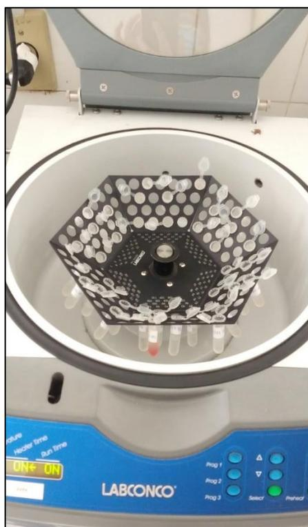
**Figura 15.** Etapa de pré-evaporação até a secura em centrífuga a vácuo.
