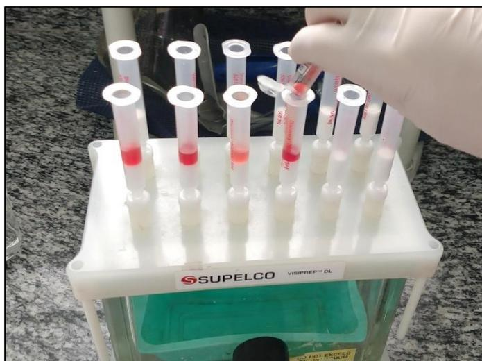
**Figura 14.** Transferência do plasma contaminado com clorfluazuron para os cartuchos.
