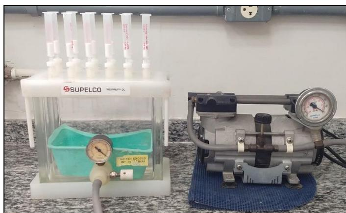
**Figura 13.** Cartuchos acondicionados sob vácuo (com auxílio de uma bomba).
