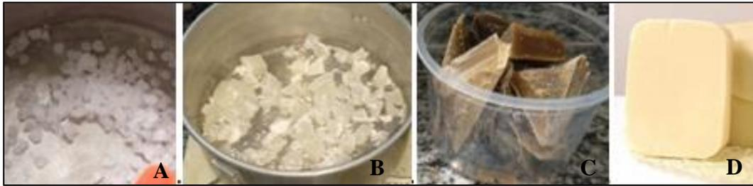
**Figura 19.** Quatro diferentes tipos de ceras utilizadas: (A) Parafina alimentícia granulada; (B) Parafina para vela; (C) Cera de abelha; e (D) Cera vegetal de coco.
