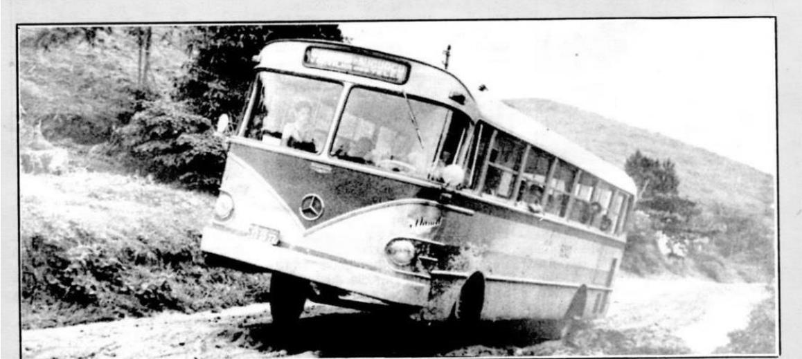
A dificuldade de se trafegar em estradas de barro era um problema sério para as empresas. Na foto, um ônibus da Municipal, com motor adaptado na traseira pela própria empresa, que precisou, também, adaptar a carroceria (frente e traseira). A vista indica a linha Caxias-Nova Iguaçu, operada hoje pela Flores.
