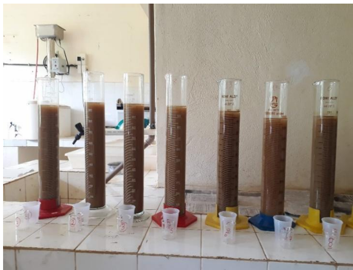
Figura 7. Detalhe da análise granulométrica pelo método da pipeta.
