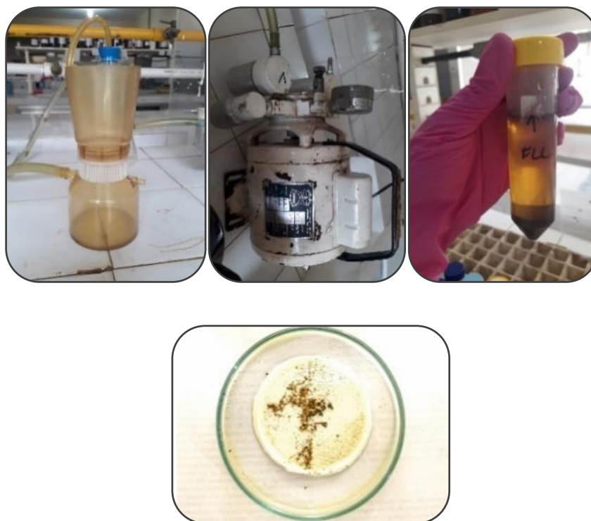
Figura 8. Resumo das etapas do fracionamento físico da matéria orgânica (FLL) por densidade: a) Sistema de filtração da Millipore; b) Bomba de vácuo para succionar a FLL; c) Frasco de centrifuga contendo a solução de iodeto de sódio e a FLL sobrenadante e d) Filtro de fibra de vidro com a FLL.
