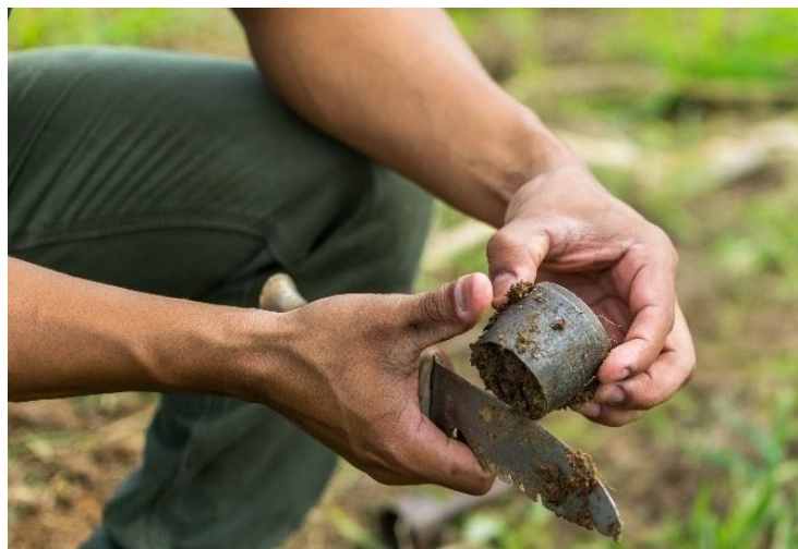
Figura 4. Coleta de amostra indeformada para determinação da densidade do solo na área de estudo.
