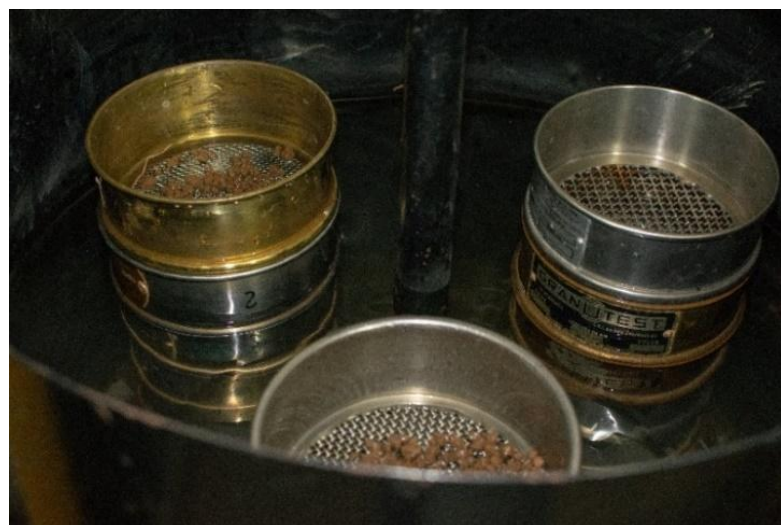
Figura 6. Conjunto de peneiras no interior do aparelho Yooder.
