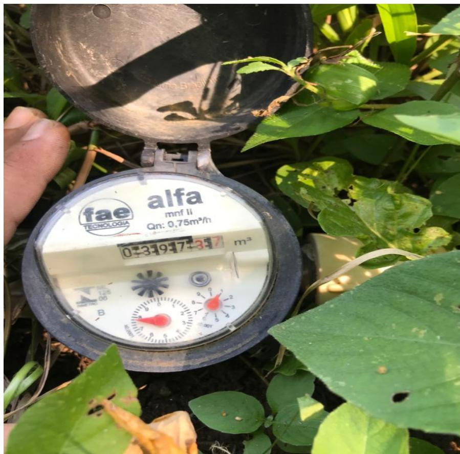
**Figura 6:** Momento da leitura do hidrômetro instalado no local do experimento, registrando o volume de água que entrava no sistema em um intervalo de 24 horas, no dia 07 de janeiro de 2019. Imagem: André Vaz, 2019.
