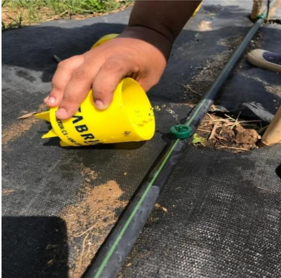
**Figura 5:** Água sendo coletada de um gotejador durante aproximadamente dois minutos, para posterior medição de seu volume e cálculo de uniformidade do sistema. Imagem: André Vaz, 2018.
