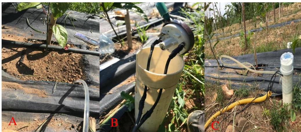
**Figura 4:** (A) Vela enterrada conectada à mangueira com água; (B) Destaque para o pressostato ligado à fonte de energia e à vela através da mangueira e (C) Sistema completamente montado. Imagem: André Vaz, 2018.
