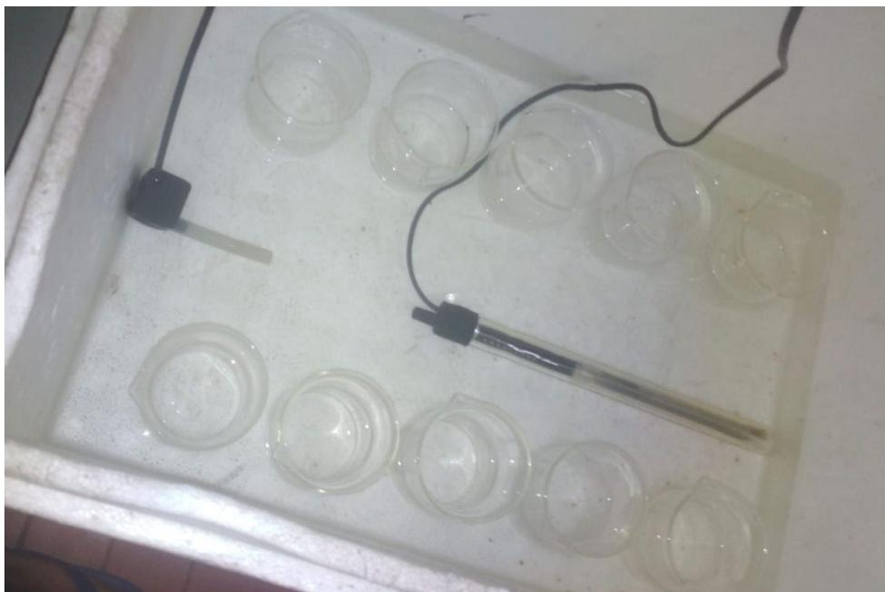
**Figura 4.** Caixa térmica utilizada para os tratamentos de 28, 30 e 33°C. Termostatos e bombas foram utilizados para a manutenção da temperatura da água durante o experimento, a cada 6 horas, a temperatura era mensurada nos recipientes.
