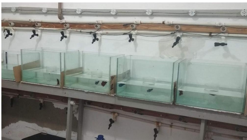
**Figura 2.** Aquários utilizados para reprodução dos peixes. As fêmeas foram mantidas inicialmente dentro de recipientes plásticos transparentes perfurados estimulando o processo reprodutivo. A fim de evitar interferências entre casais, foram alocadas barreiras visuais entre os aquários.
