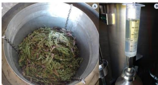
**Figura 15.** Destilação por arraste a vapor. A. Caldeira com ramas de *Lavandula dentata*; B. Hidrolato e óleo essencial no momento da extração. Fonte: Ana Rosa de Figueiredo, 2019.
