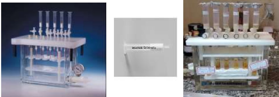
Figura 6. Extração em fase sólida com uso de Manifold e cartucho SPE.
