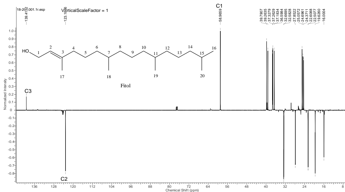
Espectro 47. Espectro de RMN ^{13}\text{C} -DEPTQ da fração \text{CSMH}_2\text{O-H} 18-20 (125 MHz; \text{CDCl}_3 ), indicando os sinais de deslocamentos químicos de carbonos do fitol.
