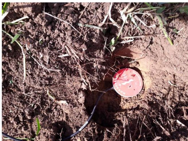
**Figura 7.** Placa de fluxo de calor no solo, instalada a aproximadamente 0,05 m de profundidade.
