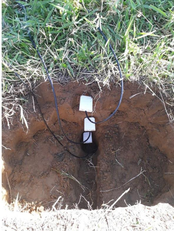
**Figura 8.** Reflectômetros de conteúdo de água, instalados a 0,10 m, 0,30 m e 0,60 m de profundidade.
