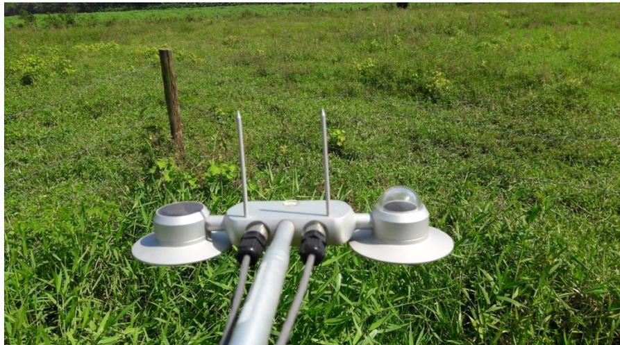
**Figura 5.** Saldo Radiômetro sobre do dossel da vegetação.
