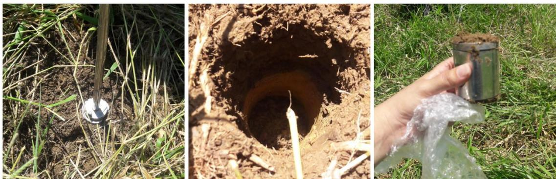
**Figura 2.** Coleta de amostras indeformadas de solo na área experimental para realização das análises físico-hídricas do solo.
