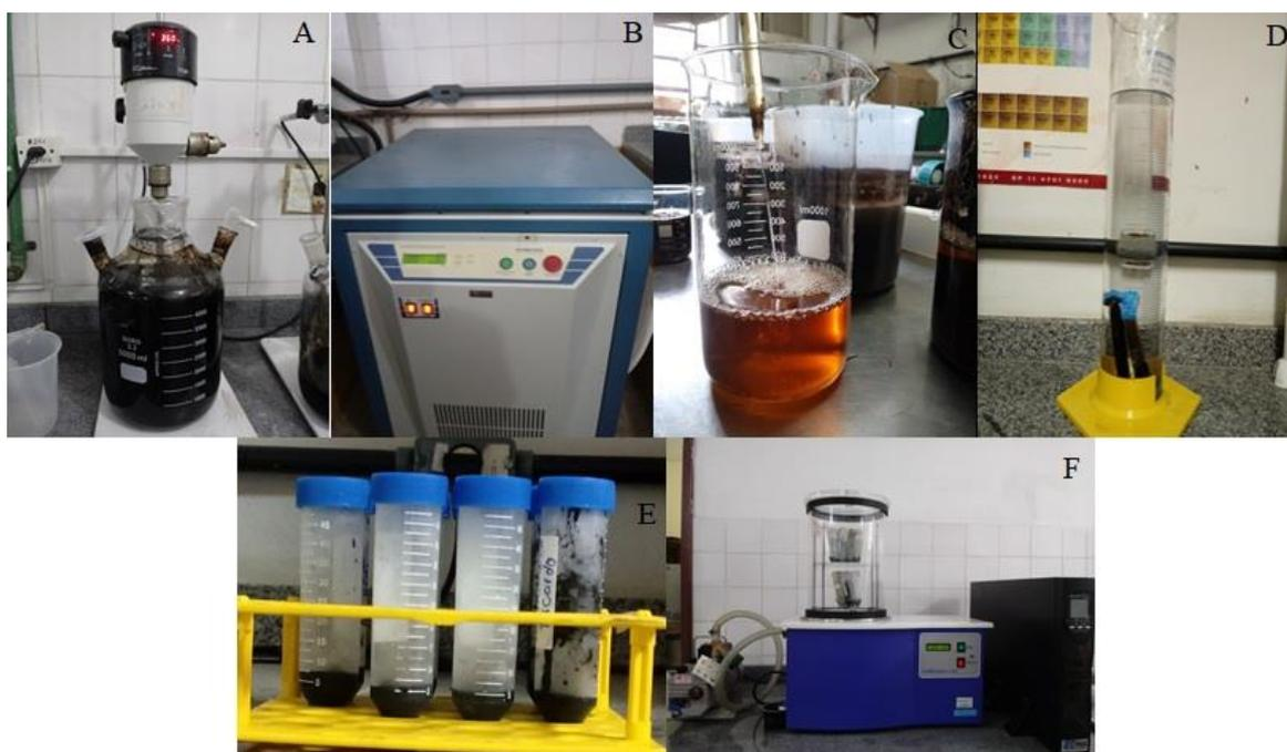
**Figura 20.** Extração (A) e centrifugação (B) das SH; separação das frações AF e AH (C); diálise dos AH (D); AH momentos antes da liofilização (E); e liofilização dos AH (F).
