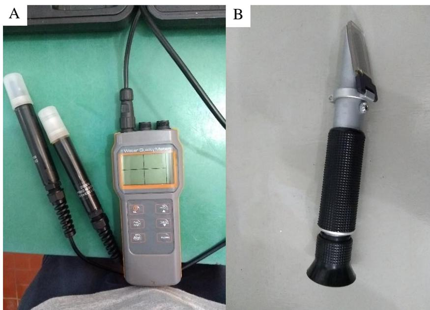
**Figura 4.** Equipamentos utilizados para análise de água: (A) Multiparâmetro Akso® e (B) refratômetro de salinidade Instrutherm® utilizados ao longo do experimento.
