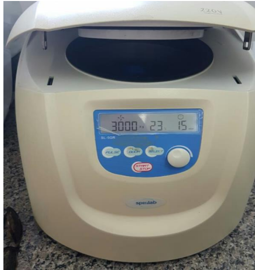
Figura 8: Amostras de humor vítreo bovino, preparadas para centrifugação (3000g, 15 minutos, a 23 °C). Fonte: arquivo pessoal.
