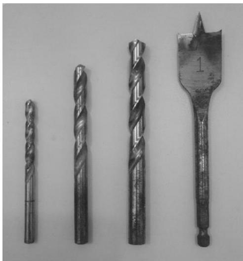
**Figura 9.** Brocas utilizadas no teste de furação, da esquerda para direita as brocas helicoidais de 6, 8 e 12 mm e a broca chata de 26 mm. Fonte: Claudia Reis
