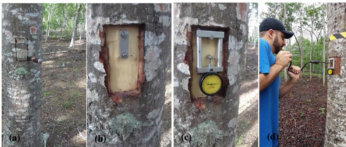
**Figura 12.** Instalação e medição das tensões/deformações de crescimento pelo extensômetro. (a) Abertura da janela; (b) Fixação dos pinos; (c) Instalação e calibração do extensômetro; (d) Perfuração no tronco com o arco de pua.
