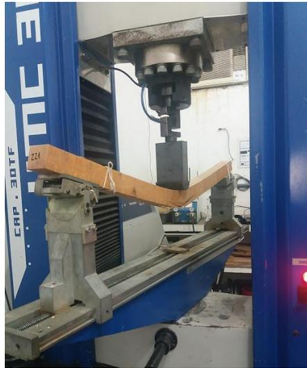
**Figura 11.** Ensaio de flexão estática realizada na máquina universal de ensaios. Fonte: Claudia Reis
