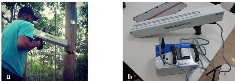
**Figura 13.** (a) Medição da amplitude resistográfica na orientação Norte-sul. (b) Resistógrafo utilizado no teste.
