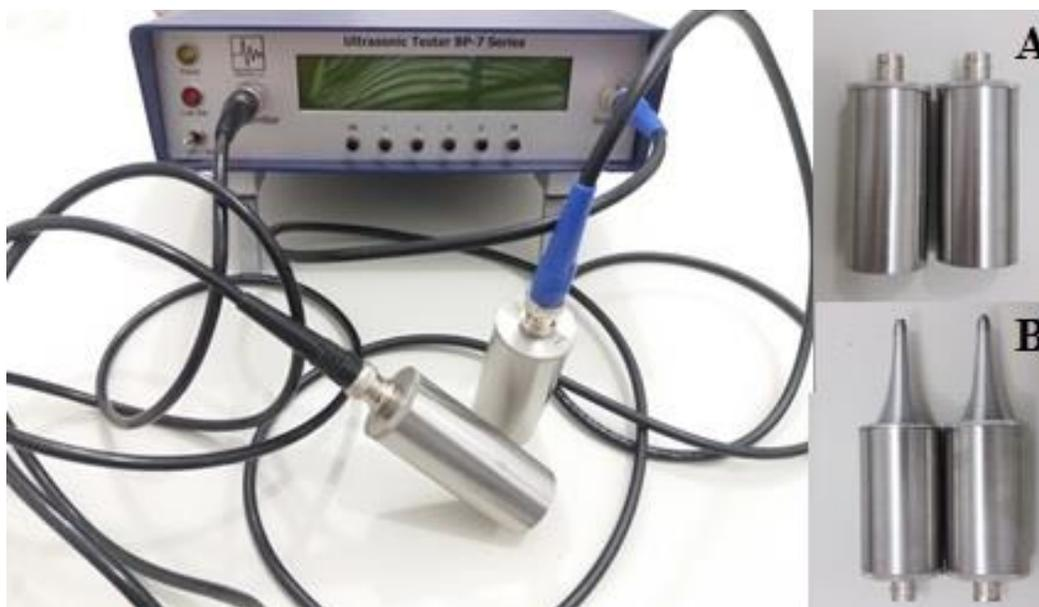
**Figura 5.** Equipamento de ultrassom Ultrasonic Tester BP – 7 Series; (A) Transdutores de faces planas; (B) Transdutores de faces exponenciais.
