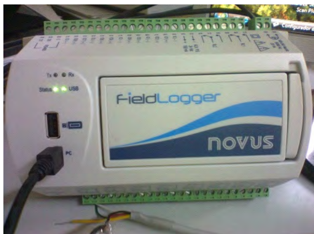
Figura 6. Registrador Eletrônico (Datalogger) fabricado pela Novus modelo Fieldlogger.
