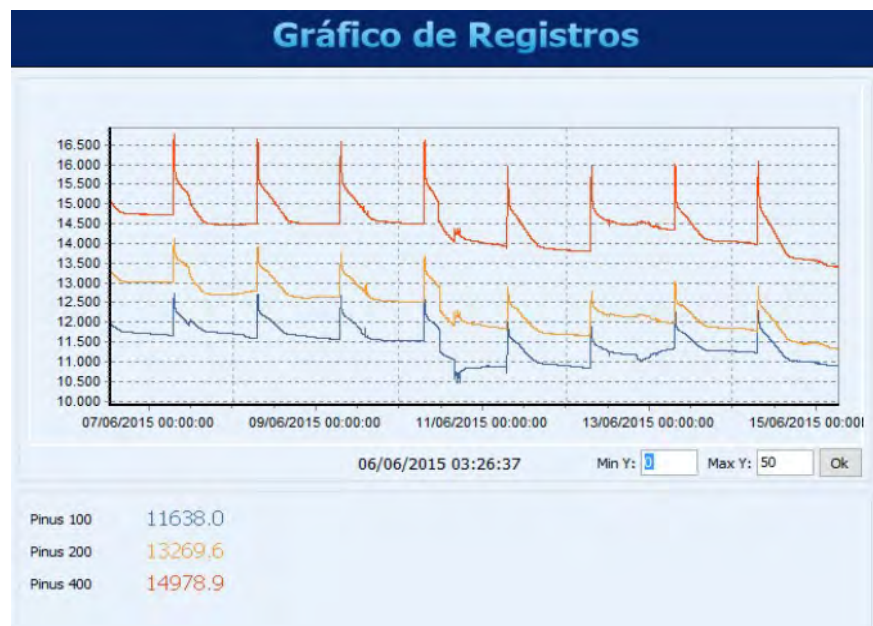
Figura 22. Gráfico gerado pelo software FieldloggerConfig mostrando as variações de massas nos minilísimetros contendo mudas de pinus, ocorridas no período de 07 a 15/06/2015.
