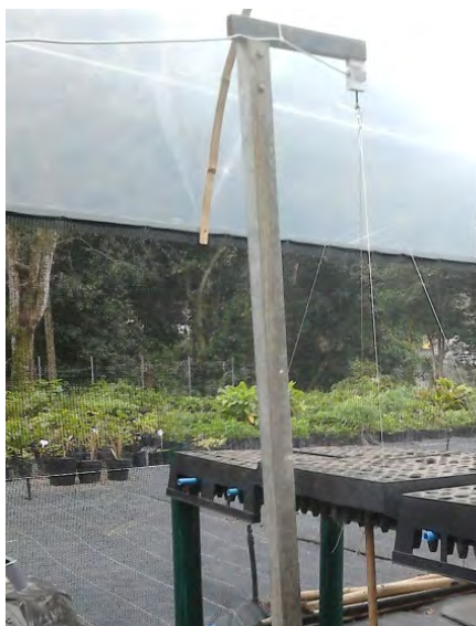
Figura 4. Minilímetro de pesagem posicionado no interior da casa de vegetação.
