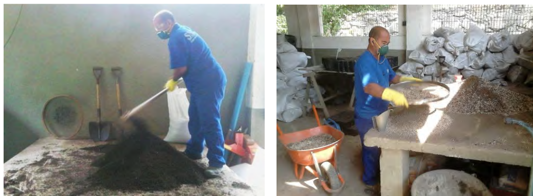
Figura 13. Homogeneização e peneiramento manual do composto contendo lodo de esgoto.
