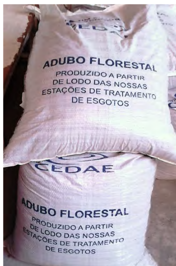
Figura 11. Embalagem contendo o lodo de esgoto estabilizado proveniente da Companhia Estadual de Água e Esgoto do Rio de Janeiro (CEDAE).
