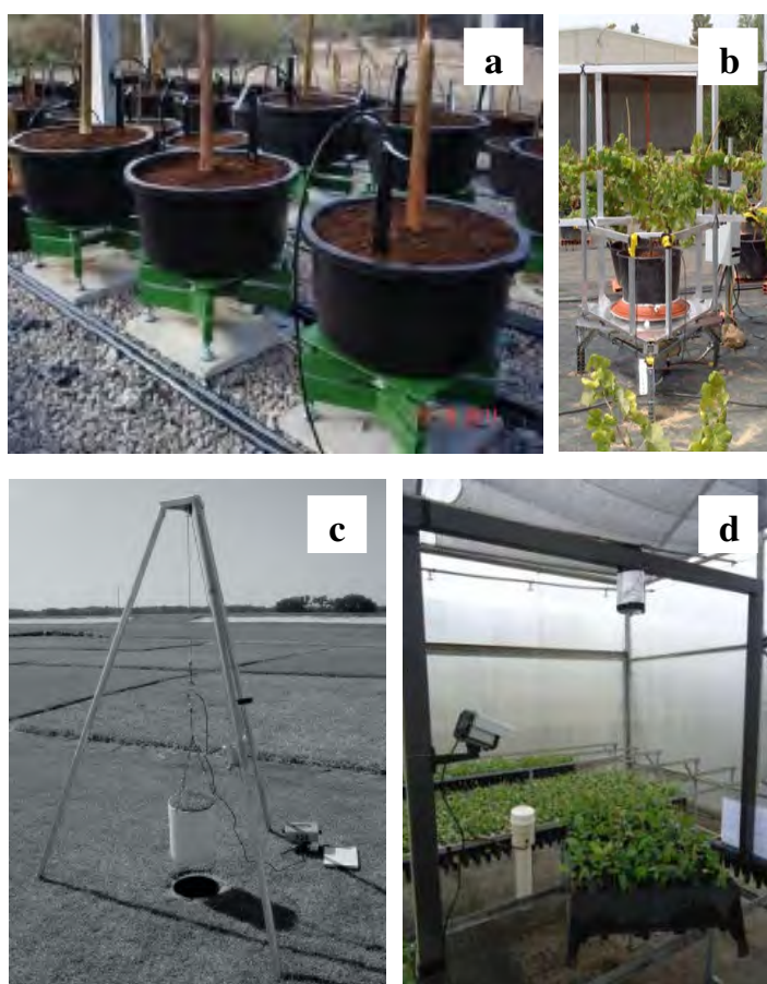
Figura 1. Modelos de minilísímetros com sistema de pesagem eletrônica desenvolvidos por (a) GERVÁSIO e JÚNIOR (2014), (b) RUIZ-PEÑALVER et al. (2015), (c) WHERLEY et al. (2009) e (d) OLIVEIRA (2012) para estudos de evapotranspiração.
