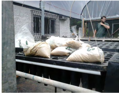
Figura 9. Processo de calibração dos minilísímetros utilizando sacos de areia como massas-padrão.
