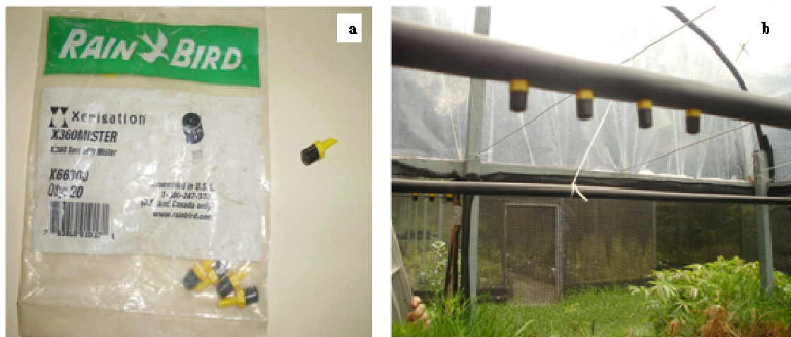
Figura 32. Embalagem com informações sobre o modelo de microaspersor da Rain Bird utilizado (a) e forma de inserção na linha lateral correspondente ao tratamento equivalente a 400% da evapotranspiração da cultura (4 microaspersores) (b).
