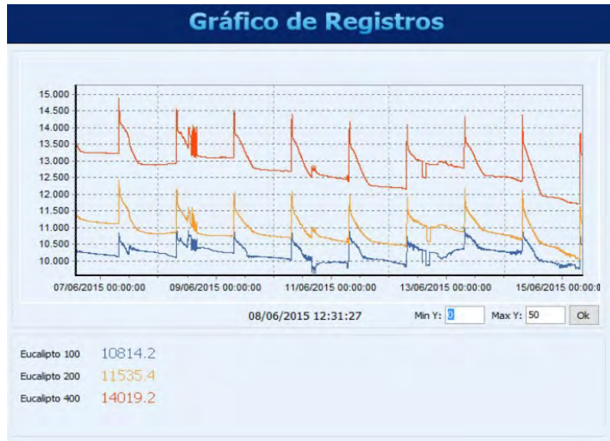
Figura 21. Gráfico gerado pelo software FieldloggerConfig mostrando as variações de massas nos minilísimetros contendo mudas de eucalipto, ocorridas no período de 07 a 15/06/2015.
