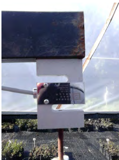
Figura 5. Célula de carga posicionada na extremidade do braço de sustentação do minilímetro.
