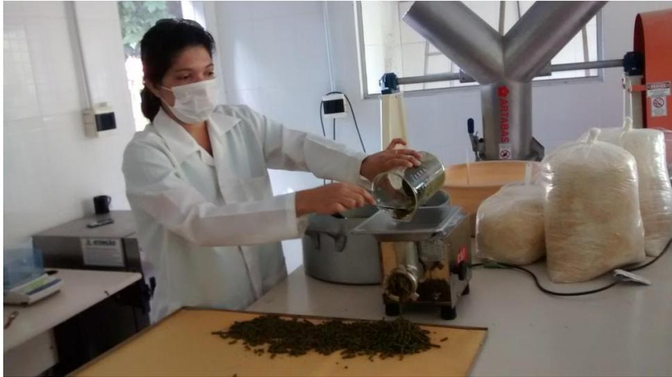
**Figura 5.** Peletização das rações experimentais no Laboratório de Alimentos e Alimentação da EAAPM – FIPERJ, Guaratiba, RJ.
