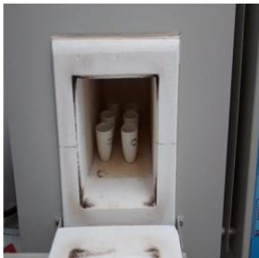
**Figura 8.** Forno mufla Quimis utilizado para a determinação de cinzas, Unidade de Tecnologia de Pescado, EAAPM – FIPERJ, Guaratiba, RJ.
