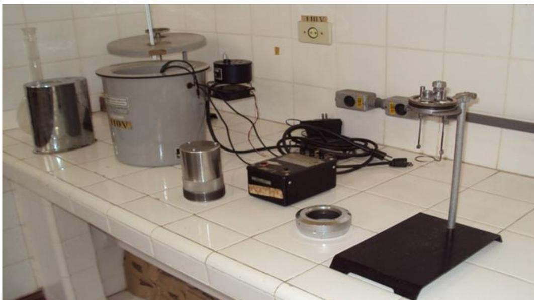
**Figura 13.** Bomba calorimétrica utilizada para determinar a energia bruta do farelo de *Ulva fasciata*. Laboratório de Bromatologia, DNAP, UFRRJ.
