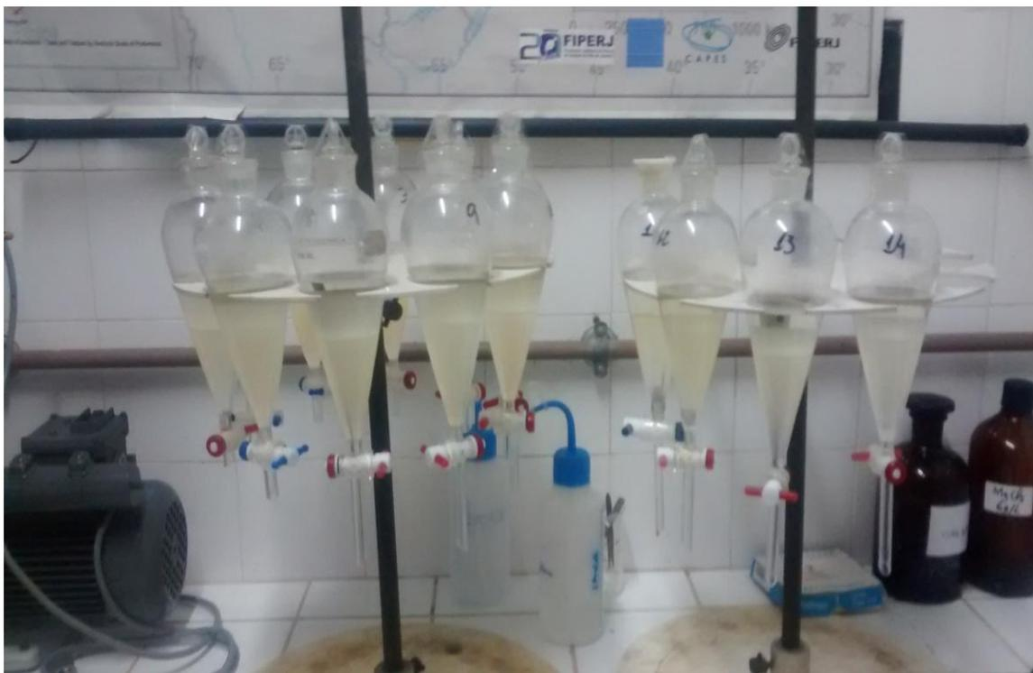
**Figura 10.** Extração de lipídeo bruto de beijupirá pelo método de Fouch, na Unidade de Tecnologia de Pescado da EAAPM-FIPERJ, Guaratiba, RJ. Partição em funil de separação
