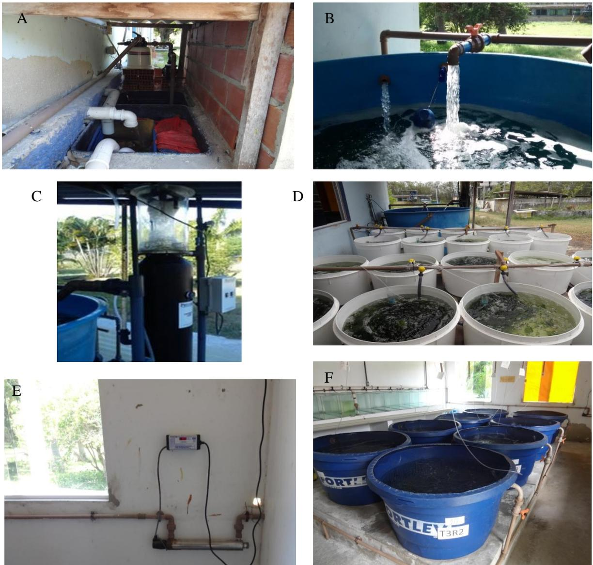
**Figura 2.** Sistema de aquicultura multitrófica integrada em sistema de recirculação de água da EAAPM – FIPERJ, Guaratiba, RJ. A: Reservatório com filtro de areia; B: Reservatório com bactérias nitrificantes; C: *Skimmer*; D: Cultivo de *Ulva fasciata* como biofiltro; E: Esterilização da água com filtro ultravioleta; F: Tanques circulares de produção de beijupirá.
