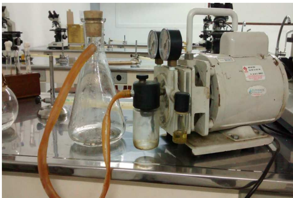
Figura 6: Inoculação da estirpe ENA 4593 de Serratia sp. em sementes de tomateiro cv. Santa Clara, com auxílio de um dessecador acoplado à bomba a vácuo no laboratório de Botânica da USS/Vassouras-RJ.
