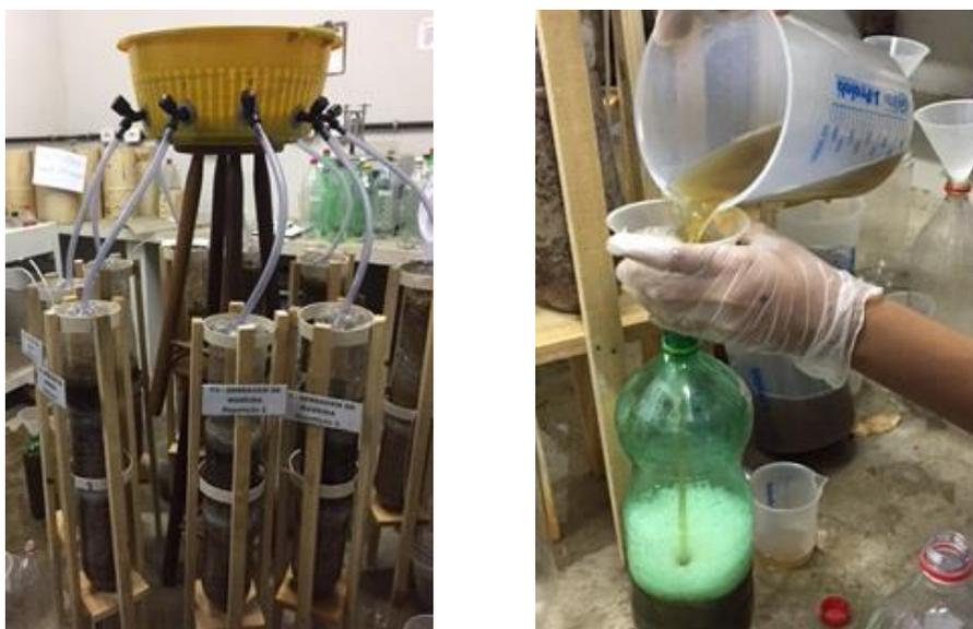
**Figura 3.** Detalhe do ensaio experimental utilizando filtros orgânicos preenchidos com cana-de-açúcar, sabugo de milho, e com serragem de madeira e, da coleta do efluente para análise, após o tratamento primário da ARB.
