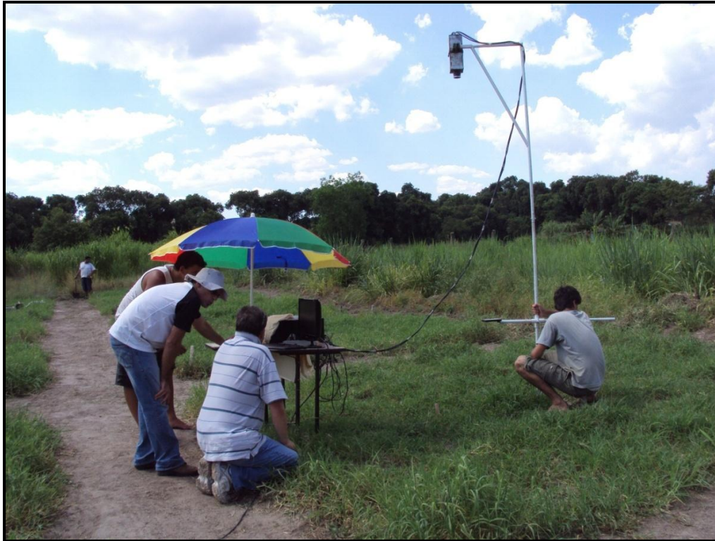
Figura 6 Aquisição de imagens com câmara multiespectral em pastagem de Tifton 85. Seropédica, RJ, 1º de março de 2012 (27 DAC), às 11:30 hora local.
