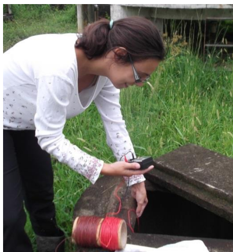
Figura II-06: Medição da profundidade do lençol freático.
