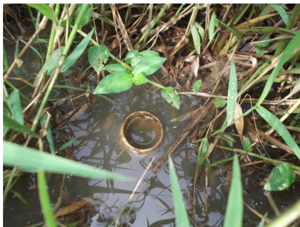
Figura II-13: Medidor Pz 04 de área não urbanizada no mês de fevereiro, apresentando lâmina de água.
