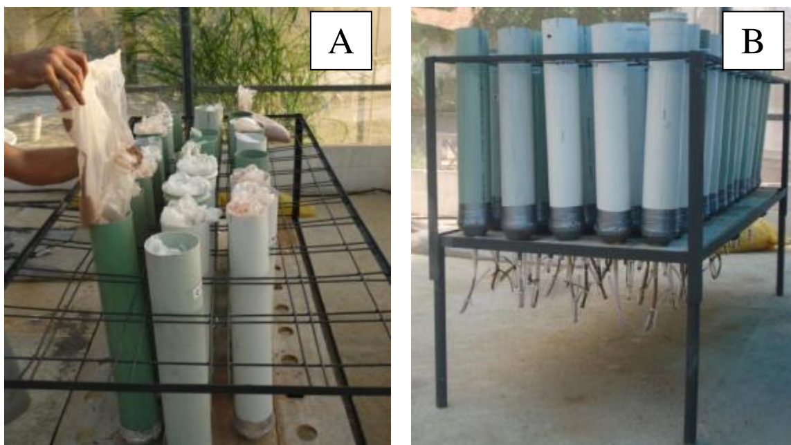
Figura 5: Acomodação dos tratamentos nas colunas de lixiviação (A). Ensaio com colunas de lixiviação no início da incubação (B).
