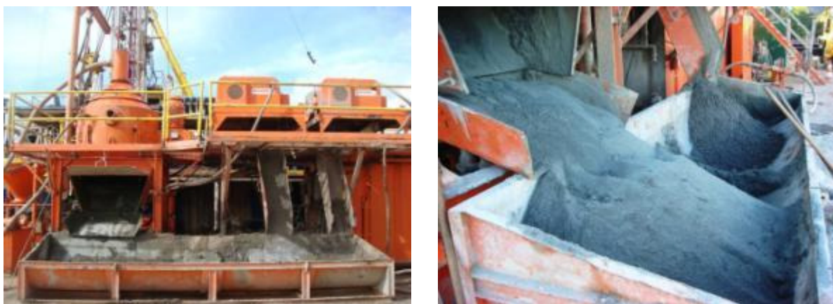
Figura 2: Sistema de recuperação do fluido de perfuração, utilizado no poço em estudo, na Bacia do Recôncavo.
