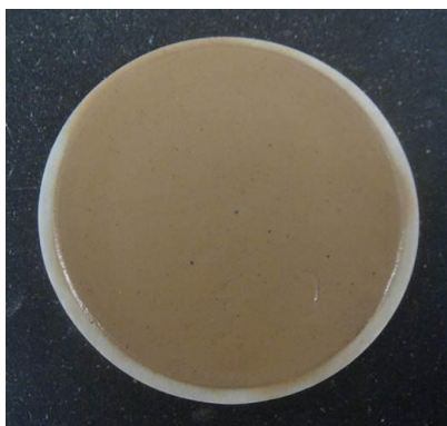
Figura 29. Foto da torta de filtração formada no experimento com fluido base água do estudo de caso I e papel de filtro com meio filtrante.
