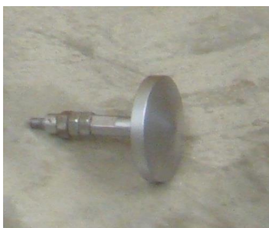
Figura 19. Foto do cone utilizado no cisalhamento da torta de filtração.
