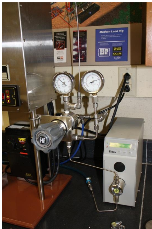
Figura 18. Foto da bomba externa de pressurização da célula de filtração.
