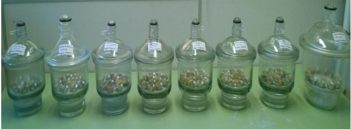
**Figura 11.** Dessecadores utilizados nos experimentos para determinação das isotermas de sorção
