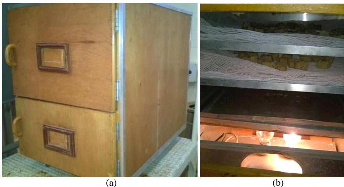
**Figura 10.** (a) Secador do tipo cabine com circulação de ar utilizado no experimento de secagem; (b) CMS de tilápia no secador
