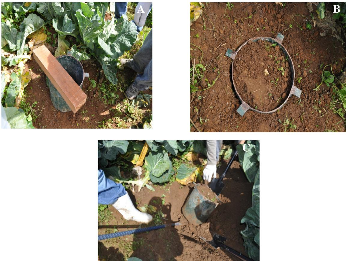
**Figura 7.** Sequência de etapas para retiradas de amostra de solo. A- Colocação do cilindro; B- Cilindro cravado no solo e C- Retirada do cilindro com amostra de solo.
