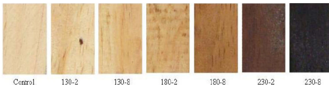
Figura 6 - Alteração da cor da madeira de Pinus brutia sob diferentes condições de temperatura (130, 180 e 230oC) e tempo (2 e 8 horas) (ATES et al., 2009).
