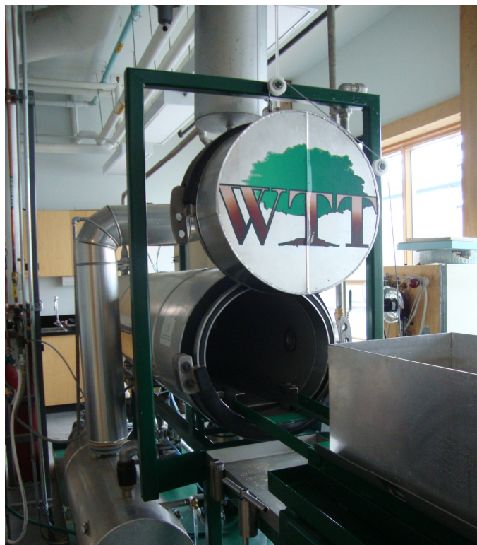
Figura 9 - Cilindro de impregnação T10 da empresa Wood Treatment Wood - WTT utilizado no tratamento da madeira de Pinus sp com nanopartículas de óxido de zinco (ZnO).
