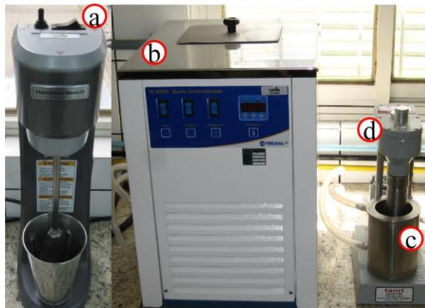
**Figura 8.** a) Agitador Hamilton Beach<sup>®</sup>, b) Banho térmico, c) copo encamisado e d) viscosímetro Fann 35A.
