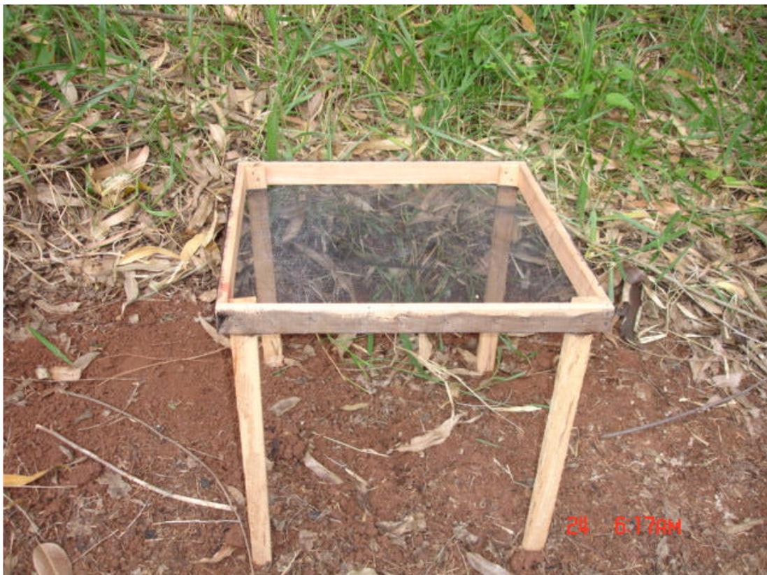
**Figura 12** – Coletor de madeira e sombrite utilizados para a coleta da serapilheira depositada.
