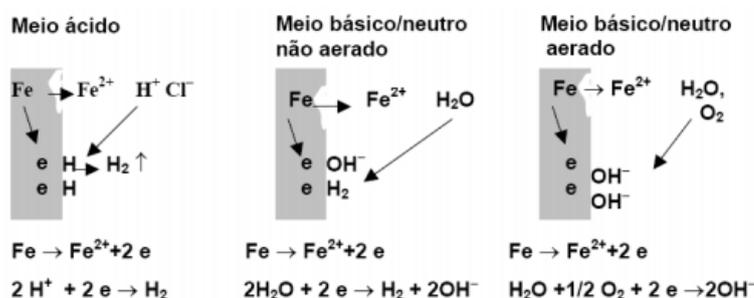
**Figura 2.** Reações eletroquímicas da corrosão em diferentes meios (MOURA, 2009).
