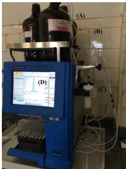
**Figura 15.** Foto do equipamento ISOLERA four da BIOTAGE. (A) Recipiente para solventes, (B) Linha, (C) Coluna de sílica SNAP Ultra 25 g, (D) Display e (E) Coletor de frações.
