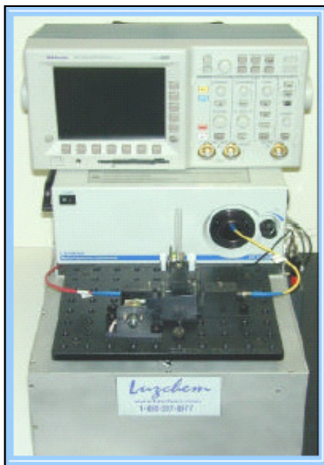
Figura 24. Sistema de fotólise por pulso de laser (laser Nd-YAG modelo mLPF112) para a absorção de transientes em modo de transmissão.
