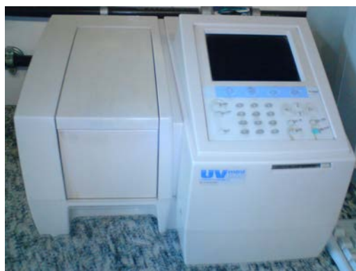
Figura 23. Espectrofotômetro de ultravioleta (UV-Vis) Mini UV Shimadzu, modelo 1240.
