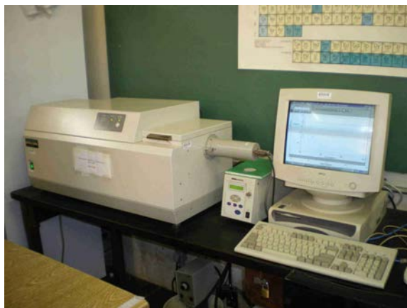
Figura 26. Espectropolarímetro J-180 Jasco, com sistema de controle interno de temperatura Jasco PTC-423S acoplado ao equipamento.
