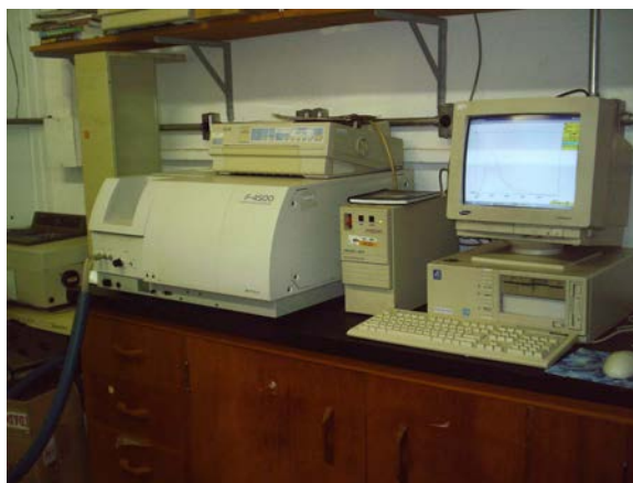
Figura 25. Espectrofluorímetro F-4500 Hitachi acoplado a um banho termostatizador de temperatura.
