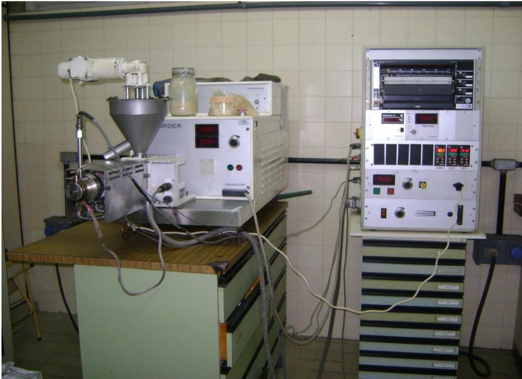
**Figura 2.** Extrusor monorosca, modelo 19/20 DN (Brabender, Duisburg, Alemanha) utilizado para a produção dos extrudados expandidos de arroz e farinha da casca do maracujá (Créditos: Carla da Silva Teba).
