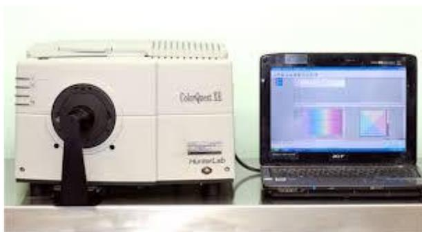
A análise instrumental de cor foi realizada por transmitância no aparelho Color Quest XE, escala CIELAB e CIELCh, com abertura de 0,375mm de diâmetro, com iluminante D65/10.
