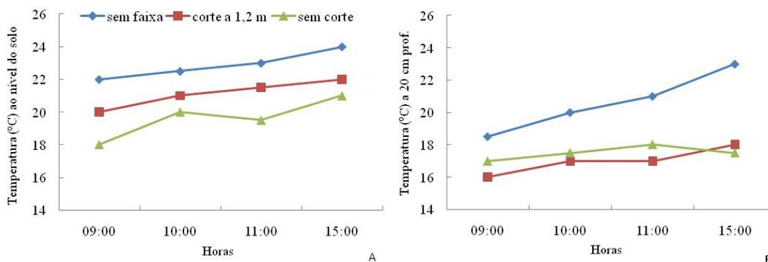
**Figura 7.** Temperatura média detectada ao nível do solo (A) e a 20 cm de profundidade (B), em função dos tratamentos adotados nas faixas de flemingia.
