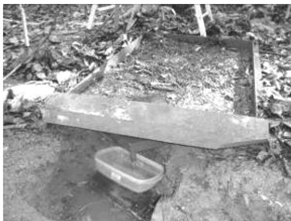
**Figura 10** – Chapa galvanizada onde se coleta o volume escoado
