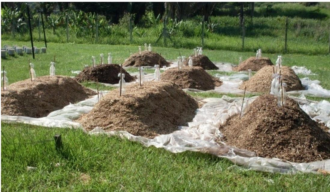
**Figura 2.** Visão geral do experimento de compostagem, após formação das pilhas e instalação das câmaras coletoras de amônia (SALE). (Autor)
