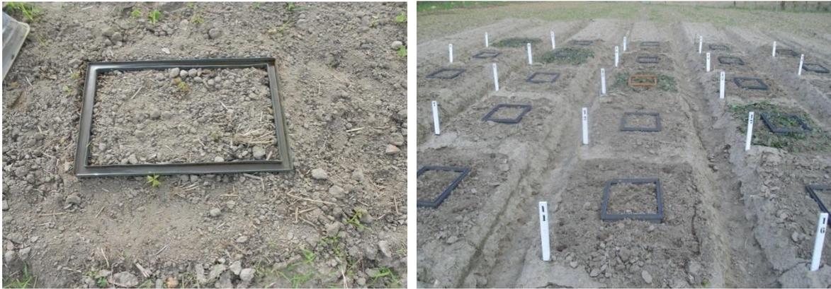
**Figura 13.** À esquerda: unidade experimental mostrando a base da câmara estática. Direita: visão parcial do experimento.
