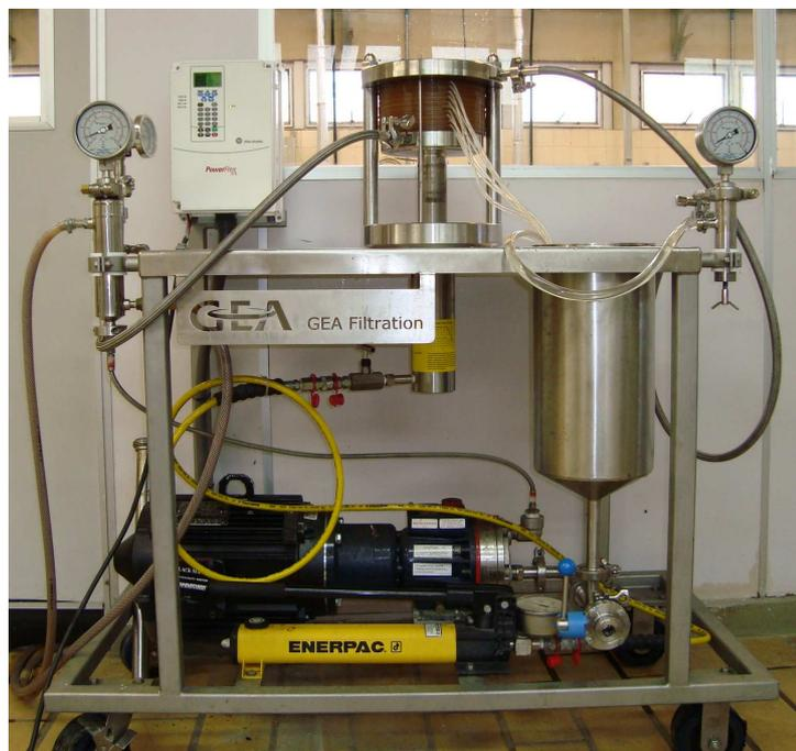
*Figura 14: Sistema de osmose inversa usado na pré-concentração do suco de camu-camu.*
