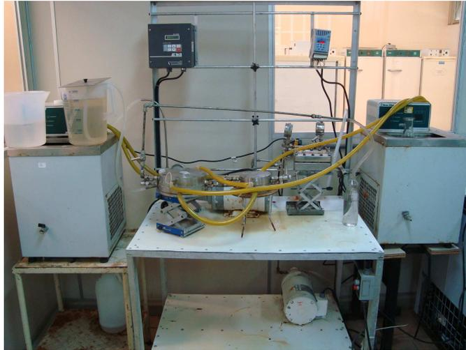
*Figura 16: Sistema de evaporação osmótica utilizado na concentração do suco de camu-camu.*
