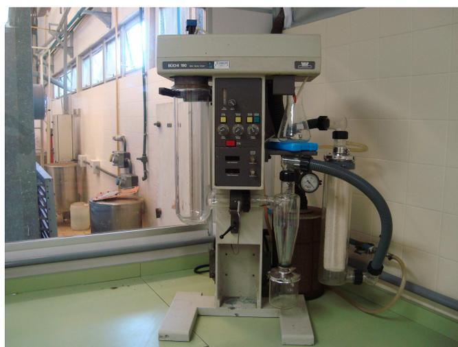
Figura 18: Sistema de microencapsulação utilizado na obtenção do suco de camu-camu microencapsulado.
