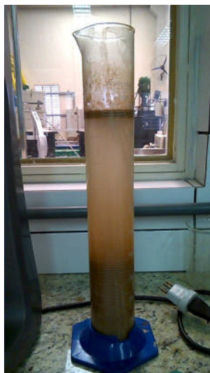
Figura 2.2 – Proveta graduada de 1 litro utilizada na avaliação da altura de interface ao longo do tempo.
