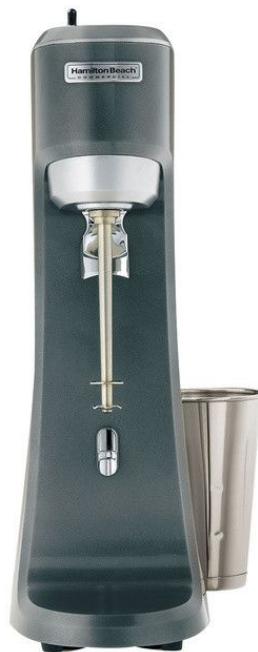
Figura 2.1 – Misturador Hamilton Beach ® utilizado na homogeneização das suspensões de barita e de calcita.
