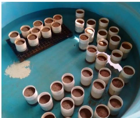
Figura 7: Colunas de solo em recipiente com água para saturação e posterior calibração das sondas TDR.
