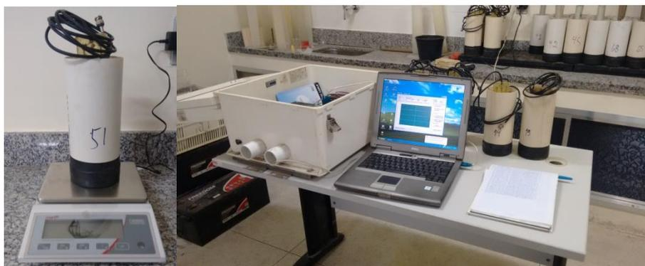
Figura 8: Medição do peso das colunas de solo com balança de precisão e monitoramento da constante dielétrica por sondas TDR.
