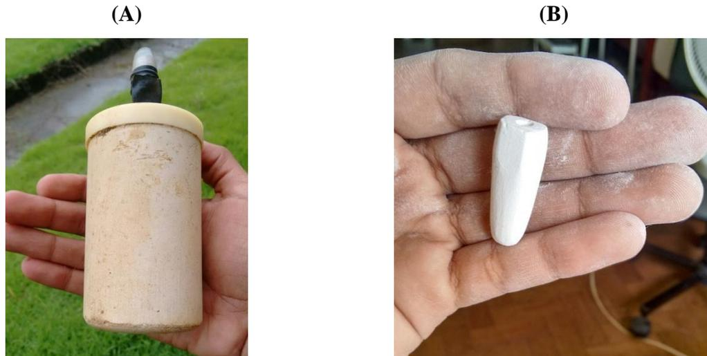
Figura 20: Vela comercial, utilizada convencionalmente como sensor no Acionado Simplificado de Irrigação (A); Sensor produzido a partir da vela comercial (B).
