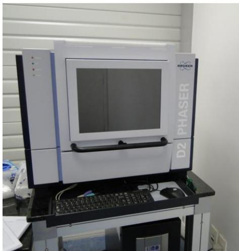
**Figura 21:** DRX D2PHASER Bruker. Fonte: PROCAT.
