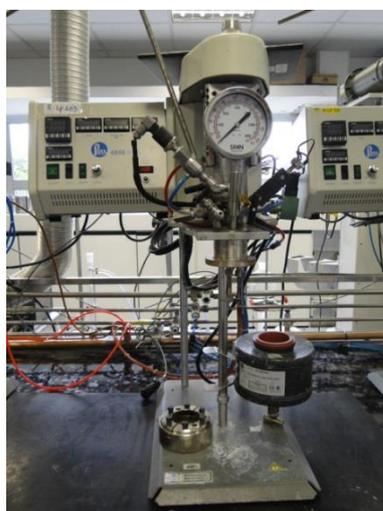
**Figura 16:** Reator de 300 mL utilizado nas sínteses da Al-SBA-15. Fonte: PROCAT.
