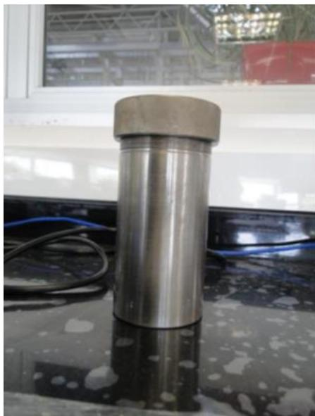
**Figura 18:** Autoclave utilizada no VPT.
