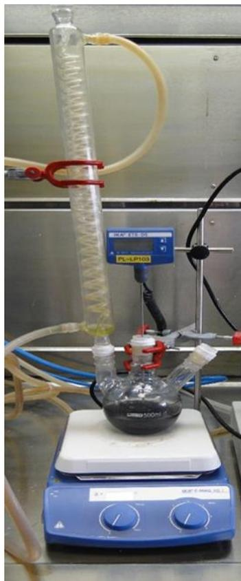
**Figura 20:** Aparato para a realização das trocas iônicas.
