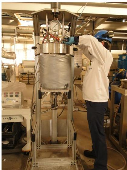
**Figura 17:** Reator de 5 galões utilizado na síntese da Al-SBA-15. Fonte: PROCAT.
