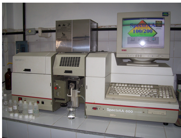
Figura 9: Espectrofotômetro de absorção de chama utilizado na quantificação de ferro e zinco.
