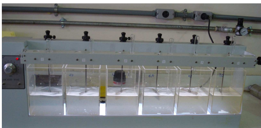
Figura 12. Equipamento de Jar Test utilizado nos ensaios (MARTINS, 2009).
