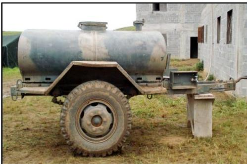
**Figura 7:** Cisterna reboque. Fonte: Arquivo pessoal, Resende, 2010.
