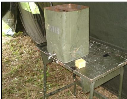
**Figura 11:** Dispositivo simples de lavagem das mãos montado no campo 4.
